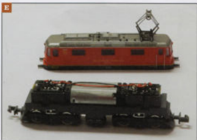
E Per completare la locomotiva recupera la cassa (uscita 43), completa di finestrini e pantografo (uscita 50).
