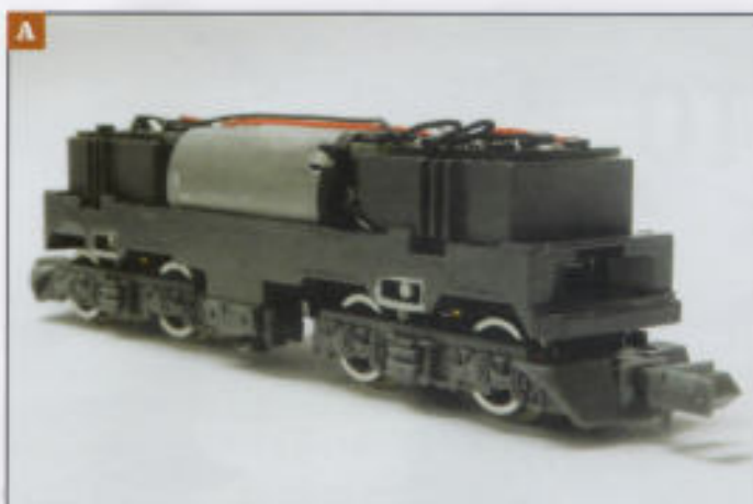
A Lo chassis della locomotiva è dotato di un motore posizionato al centro, per ottenere una distribuzione ottimale dei pesi.
