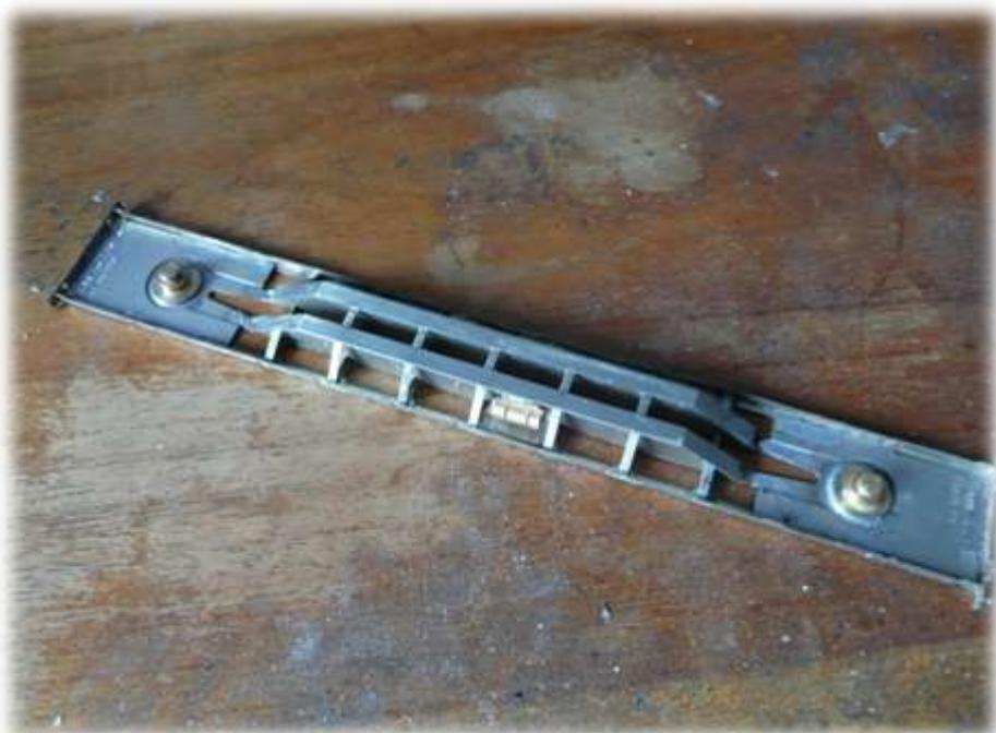
Dopo aver staccato e rifinito i respingenti, vanno saldati inserendo la piastra del respingente (non numerata) tra telaio e respingente
