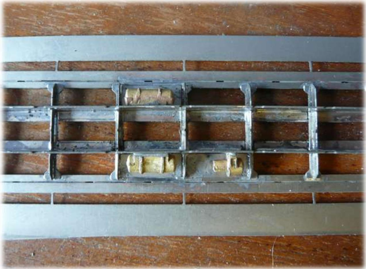
Adesso si posizionano i pezzi "2B" e "3B" all'interno della gondola saldata al telaio; anche qua ci si può aiutare con metà dima per avere le distanze corrette.
