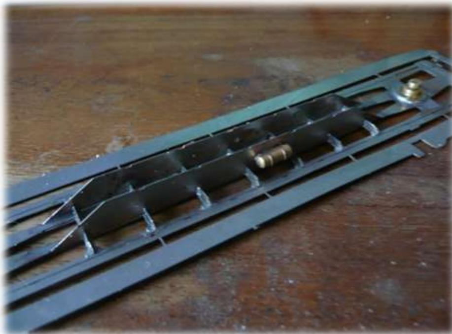
I pezzi "9" devono essere posizionati e saldati in corrispondenza dei serbatoi e del cilindro del freno
