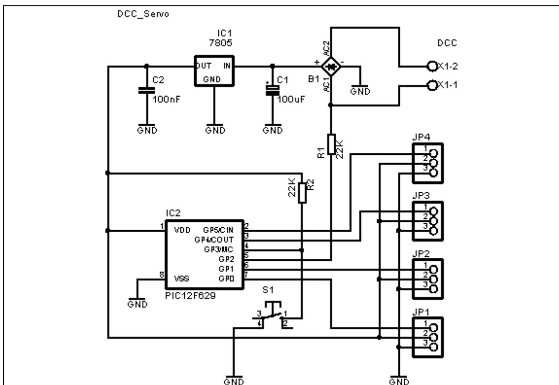
Para controlar un servo tendremos que aplicar un pulso de duración y frecuencia específicos. todos los servos disponen de tres cables dos para alimentación Vcc y Gnd y otro cable para aplicar los pulsos de control que harán que el servo se mueva a la posición indicada por la anchura del pulso (pin 1 de cada conector para el servo)
