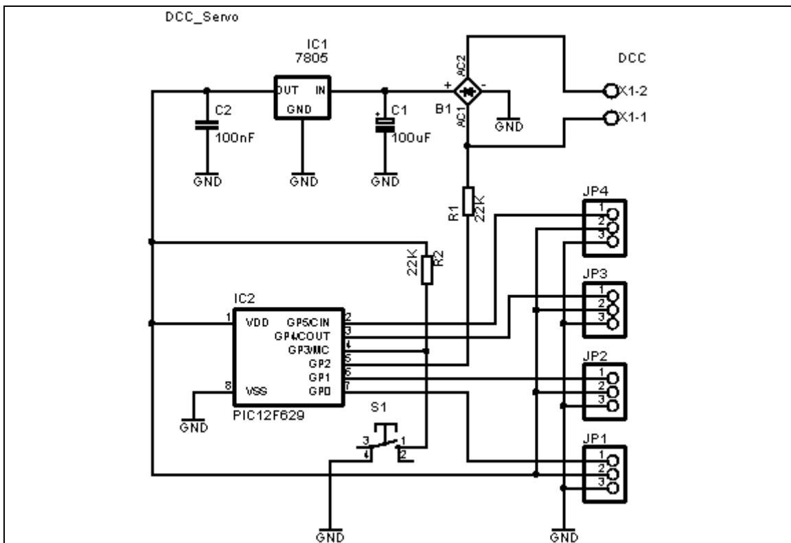
Pour contrôler un Servos nous devons lui envoyer une pulsation de durée et de fréquence spécifiques. Tous les Servos possèdent trois câbles, deux pour l'alimentation Vcc et Gnd et le troisième, pour lui appliquer les pulsations de control qui feront fonctionner le Servos a la position indiqué dû a la longueur de la pulsation (Pin 1 de chaque connecteur pour le Servos).
