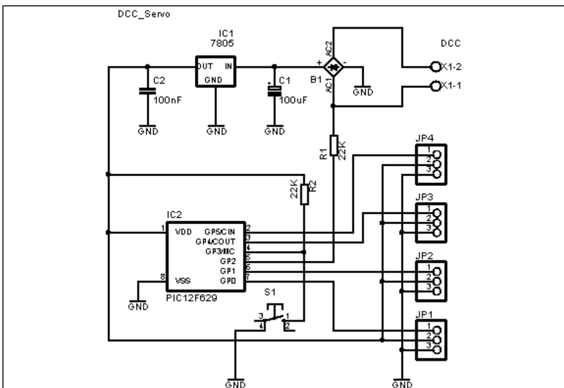
Per controllare un servo è necessario applicare un impulso di durata e frequenza specifica. Tutti i servocomandi dispongono di tre cavi: due per alimentazione (Vcc e Gnd) e uno per applicare gli impulsi di controllo che stabiliranno la posizione raggiunta dal servo in base alla loro durata (pin 1 del connettore del servo).
