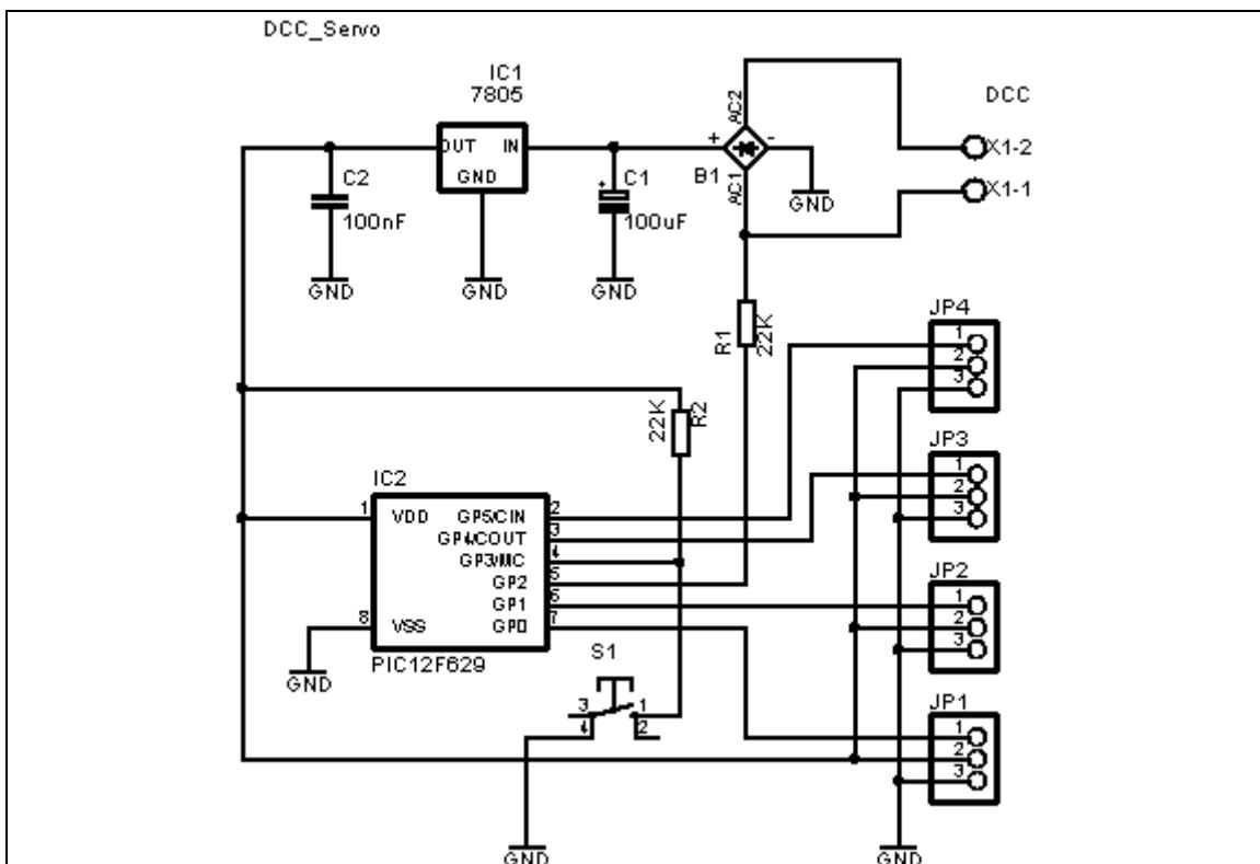
Om een servo aan te sturen heb je een puls van een specifieke duur en frequentie nodig.
